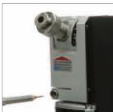
Präzise Längjustierung der Elektrode.
