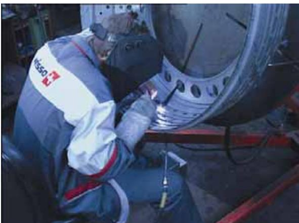
**Bild 31 WIG-Schweißen bei der Reparatur von Triebwerksteilen**
