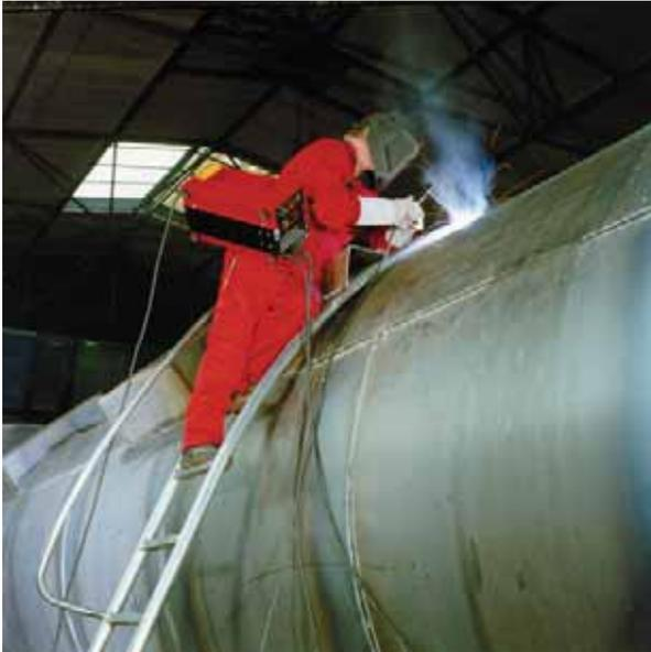
**Bild 21** Anwendung des E-Hand-Schweißens im Behälterbau
