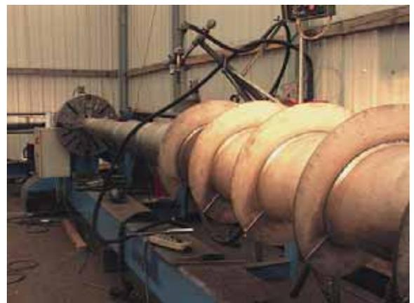
**Bild 4 Hartauftragung von Förderschnecken**
