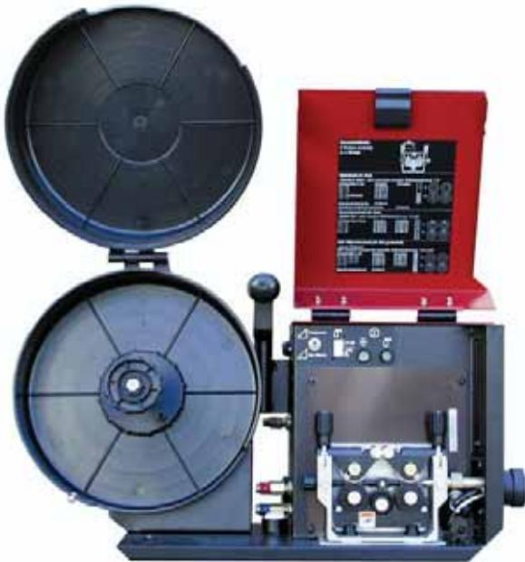
**Bild 13** Blick in ein Drahtvorschubgerät mit 4-Rollenantrieb
