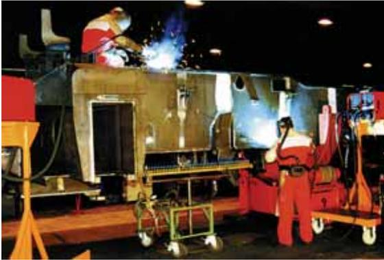
**Bild 3 Verschweißen von Feinkornbaustählen im Kranbau**
