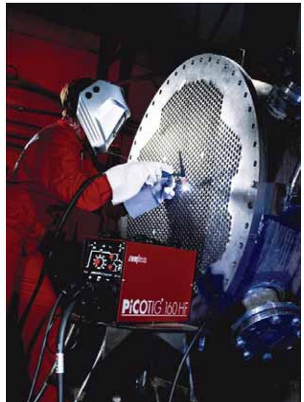
**Bild 32 WIG-Schweißen beim Einschweißen von Rohren in Rohrböden**
