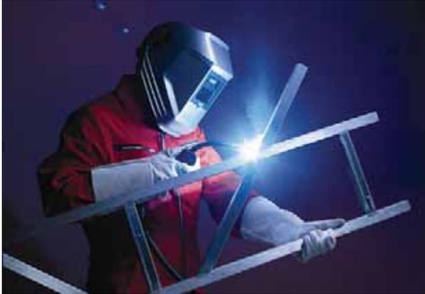
**Bild 1** MAG-Schweißen im Handwerksbetrieb
