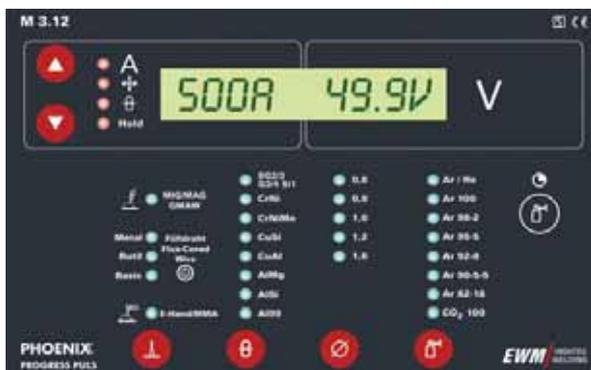
**Bild 33** Display des Schweißgerätes PHOENIX PROGRESS
