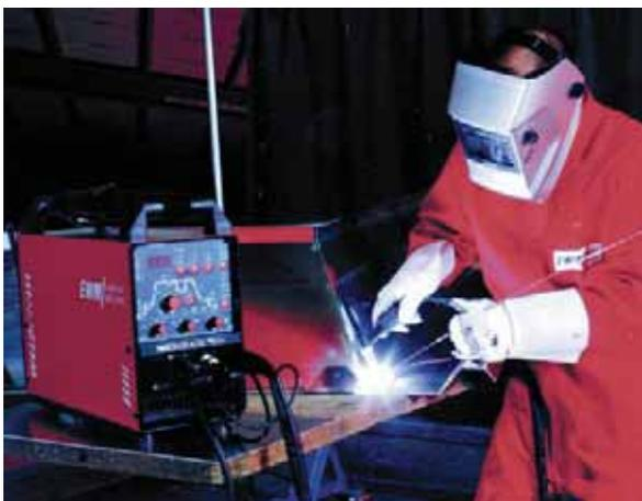
**Bild 27** TRITON 220 AC/DC, WIG-Inverter-Schweißgerät
