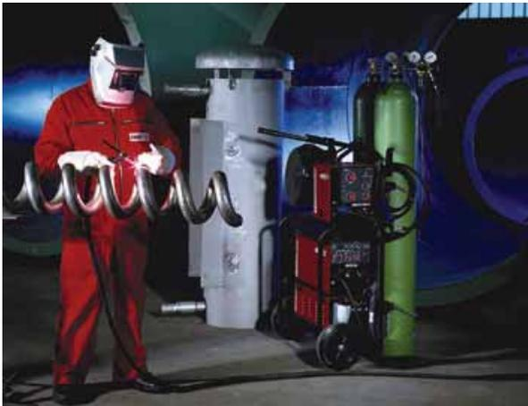
**Bild 1** TRITON 260 DC, WIG-Verschweißen von Kühlschlangen
