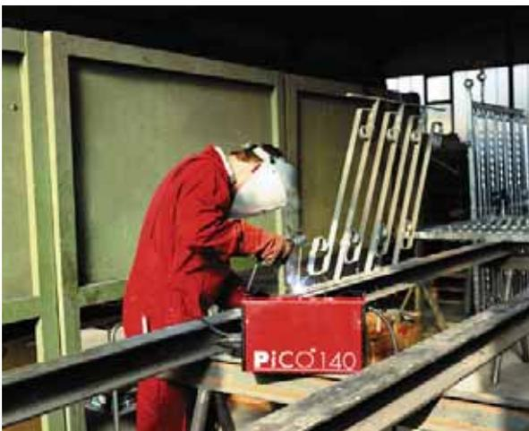
**Bild 22** Anwendung des E-Hand-Schweißens beim Geländerbau
