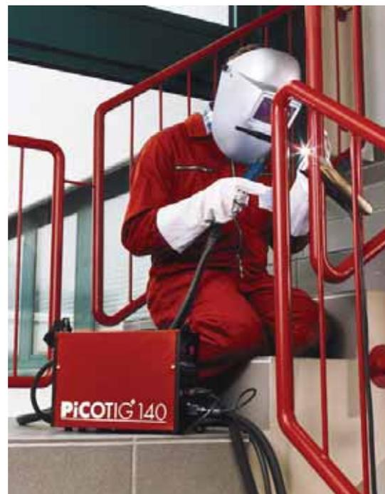
**Bild 4 WIG-Schweißen an einem Geländer**
