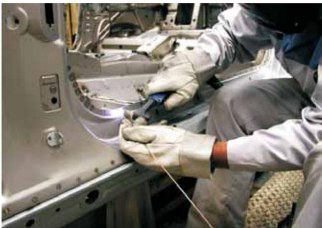
**Bild 22: Manuelles Plasmalöten am Türschweller einer BMW-PKW-Karosserie**
