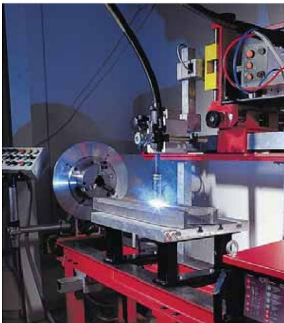
**Bild 36 Vollmechanisiertes Schweißen**
